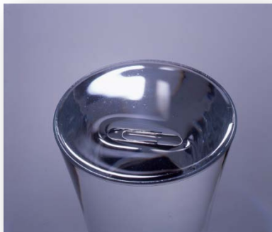
Vänster: Vattnets ytspänning gör att gomet kan ligga kvar på vätskeytan. Höger: Krafterna som verkar vid ytan är riktade nedåt, medan krafterna mellan vattenmolekylerna i lösningen är riktade åt alla håll.
