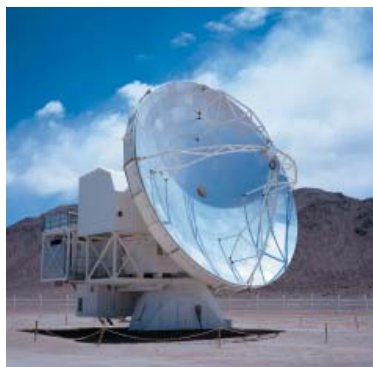
Fig. 10. Onsala rymdobservatorium är delägare i APEX (Atacama Pathfinder Experiment) 12-metersteleskop på 5100 meters höjd i Atacamaöknen i Chile. Här kan man observera kontinuumstrålning vid 345 och 810 GHz, liksom spektrallinjer mellan 211-370 och 1250-1384 GHz. (Foto: ESO.)
