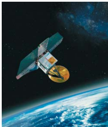
Fig. 6. Odinsatelliten sköts upp 20 februari 2001 med en Start-1 raket från Svobodny i Ryssland. Banan är sol-synkron med en höjd av ca 600 km. Detta projekt är svensklätt i samarbete med Frankrike, Kanada och Finland. Odins tid delades av astronomer och aeronomer som observerar vatten, ozon och kolmonoxid i jordens atmosfär. Åke Hjalmarson har varit astronomikoordinator för astronomiobservationerna. (Bild: Rymdbolaget.)
