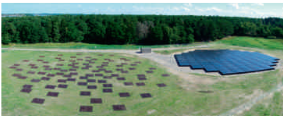
Den nya LOFAR-stationen vid Onsala rymdobservatorium som byggdes 2011 med två uppsättningar av antenner. (Källa: Onsala rymdobservatorium, L. Helldner)
