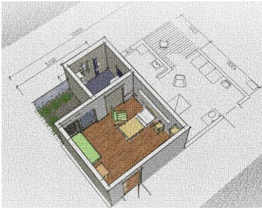
30. Enpatientrum med RWC placerade i fasad och balkong
