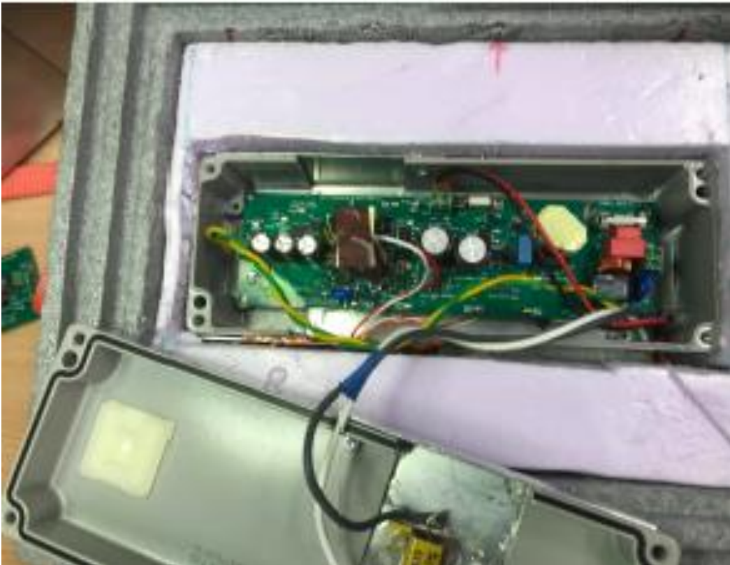
Exempel på testkrets i låda för termisk förlustbestämning
